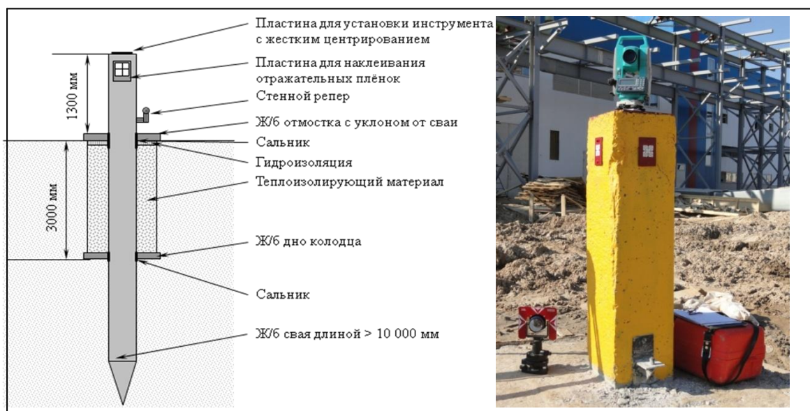
Рис. 1. Схема свайного опорного геодезического пункта (ОГП)
