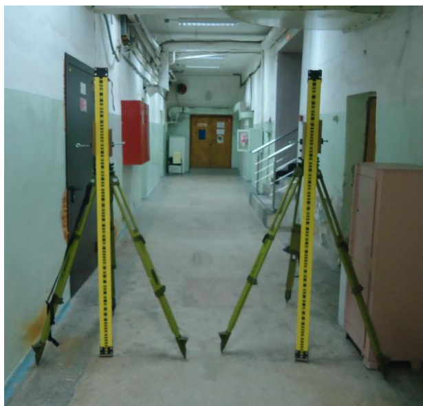
Рис. 1. Схема закрепления штрих-кодовых реек
